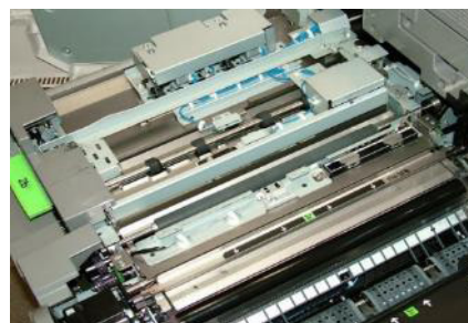
L'unità di trasporto del sistema di allineamento consente di registrare la carta con un grado di precisione di +/- 0,5 mm.
