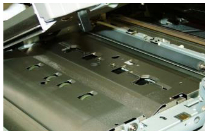
Una porta di registro raddrizza la carta e poi si abbassa mentre il foglio avanza verso il sensore di immagini a contatto per ulteriori regolazioni.
